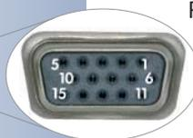
Разъем интерфейса MX камеры MOBOTIX (D Sub 15 HD) включает в себя **один входной сигнальный вывод и один выходной сигнальный вывод для включения внешних устройств**. Кроме того, разъем имеет **два сигнальных входа и два сигнальных выхода интерфейса RS-232**. Сигнальные входы/выходы камеры могут использоваться для обнаружения открывающейся двери (с помощью геркона) или для включения внешнего устройства (например, лампы).
