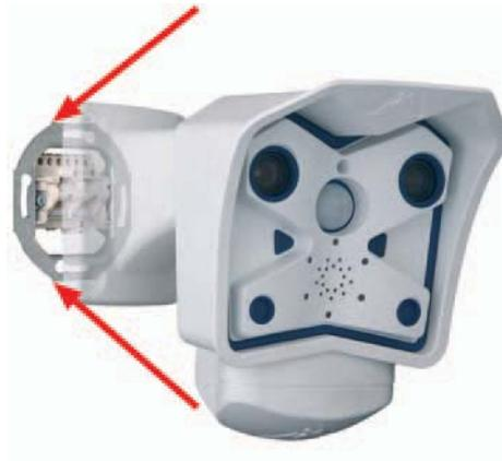
При установке **на стену вскройте одно из четырех отверстий на опоре крепления с помощью плоскогубцев**. Это обеспечит правильное направление кабеля в креплении. При установке камеры вне помещения нужно вскрыть то отверстие, которое направлено вниз. Для получения дополнительной информации по этой теме, смотрите раздел 2.14, Установка камеры на различных поверхностях.
