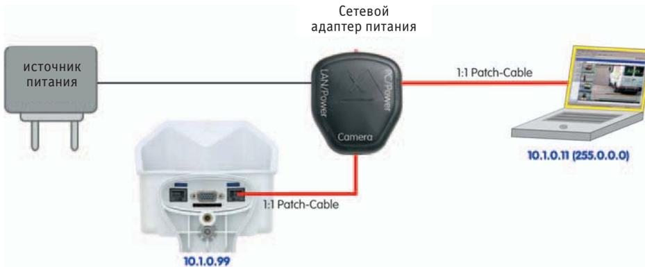
*Сетевой адаптер питания заменяет соединительный кабель (кроссовер) при прямом подключении к компьютеру*
