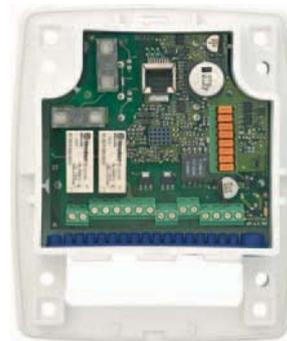
*Дополнительный блок для различных вариантов подключения дополнительных устройств и датчиков*
