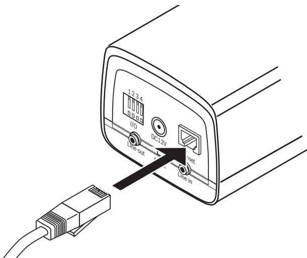
**Рисунок 3.2** Сетевое соединение
