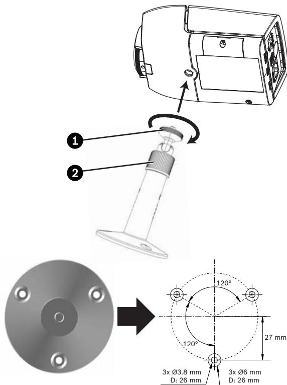
**Рисунок 3.7** Установка камеры
