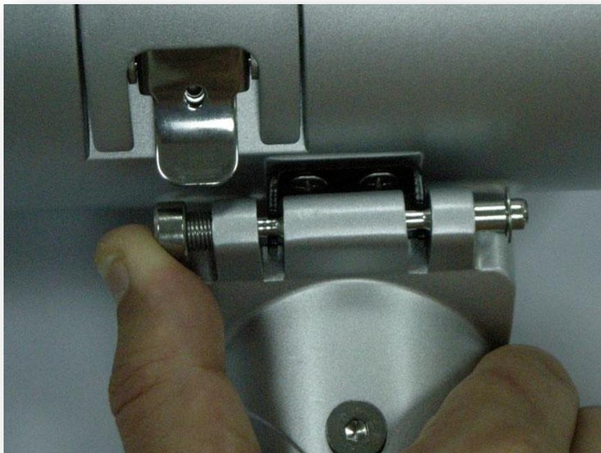
7. Сейчас камера держаться кронштейном, и вы можете регулировать изображение камер через 2 винта(1 и 2), потом крепко завинтить их.
