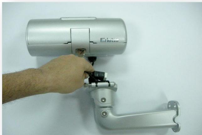
5. Потом привинтить крючок кронштейна на корпусе.
