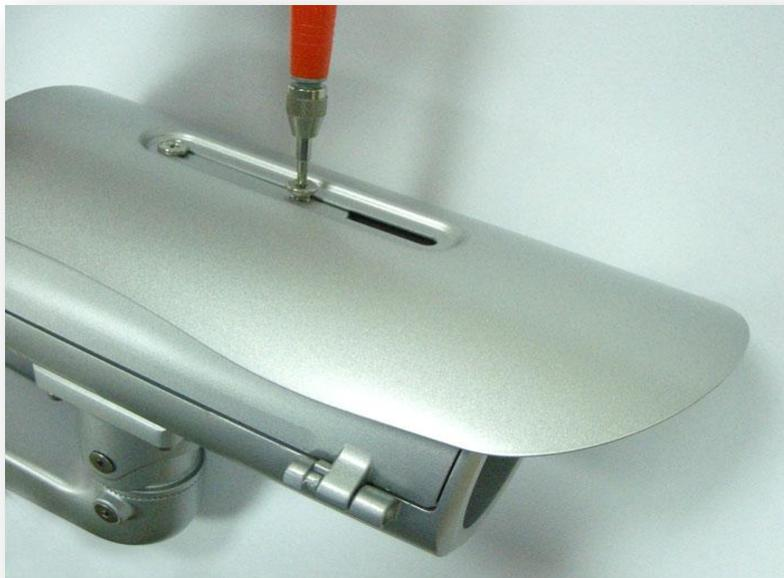
9. Закрепить камеру в крепёжной пластине шестигранным ключом.
