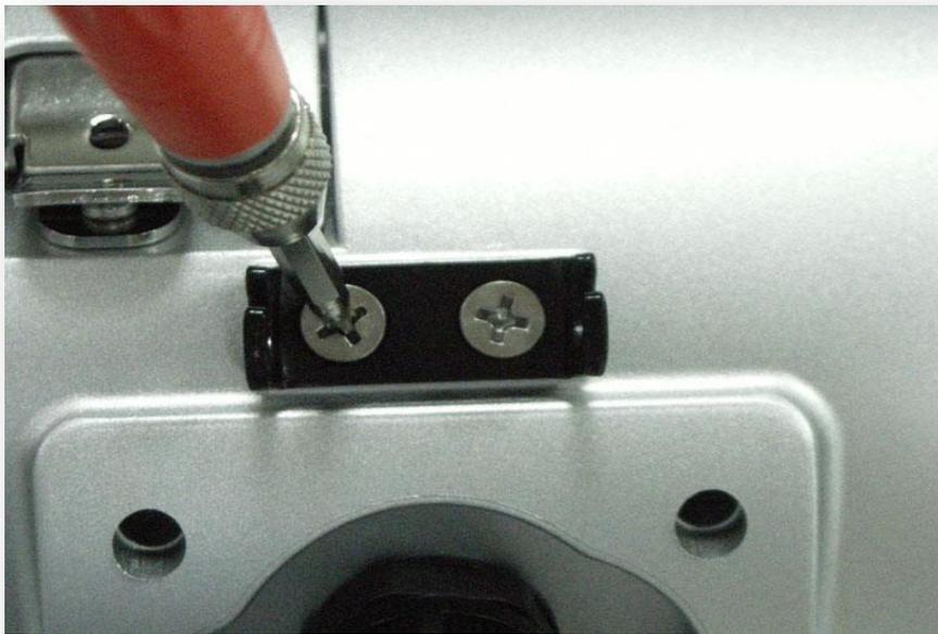
6. Затем нажать болт и зацепить крючок кронштейна чтобы установить камеру на кронштейне.
