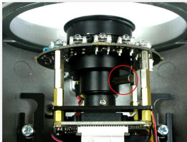
11. Когда камера полно устойчивый, запереться пружину предохранительным винтом.
