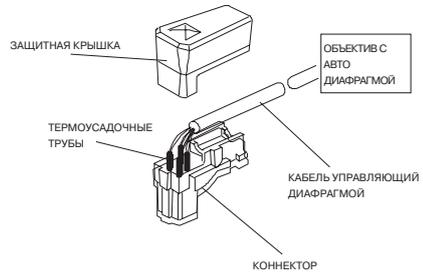
2. Снимите защитную крышку и прикрутите объектив, поворачивая его по часовой стрелке.
