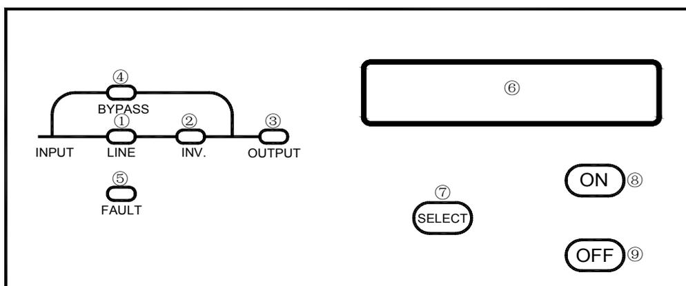
Рис. 3.3-1 Лицевая панель ИБП INELT Monolith K 20000LT
